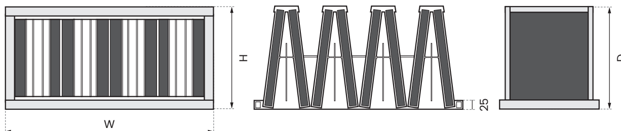
Données techniques pour différents modèles de filtres à charbon actif UltraSorb CW292
